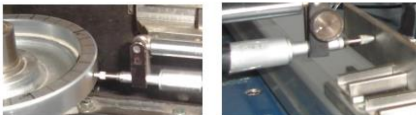
Fig. 4.5.5 Măsurarea în regim dinamic cu traductorul pe principiul inductiv, HOTTINGER
