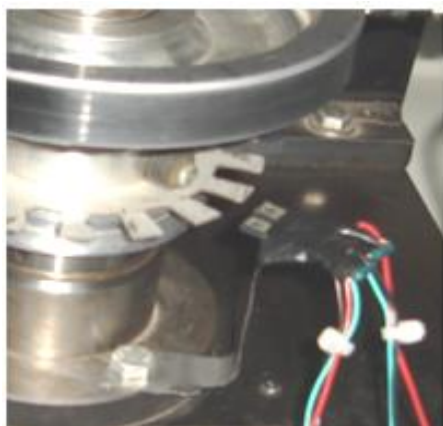
Fig. 4.3.3 Dispunerea senzorilor magnetici pentru contorizarea unei rotații complete a reperului
