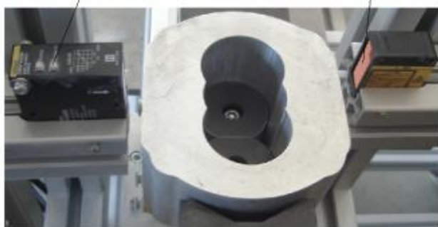
Fig. 5.1.3 Dispunerea traductoarelor de deplasare, pentru controlul cotei laterale a piesei prelucrate [B22]
