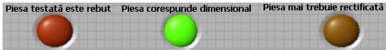
Fig. 2.4.2 Indicatorii pentru afișarea sintezei rezultatului inspecției dimensionale pentru un reper testat [B6]
