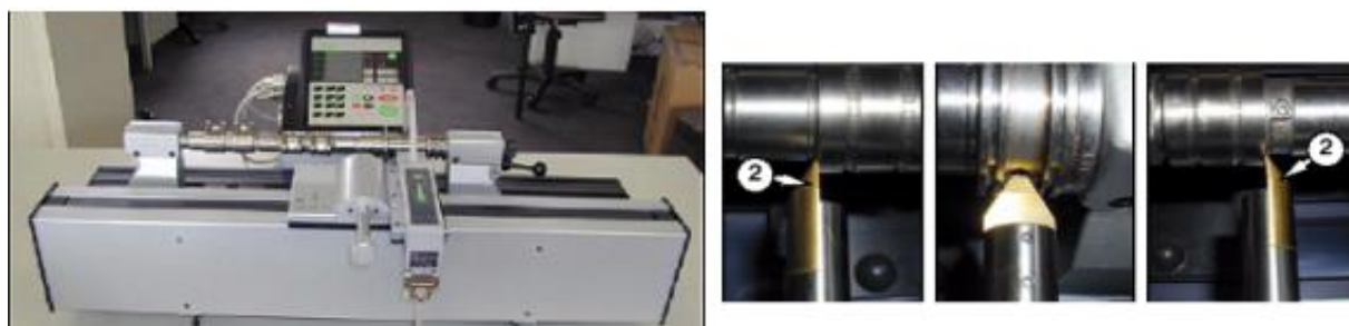
Fig. 1.2.9 Standul complex de măsurare HELIO – RONDO [M13], [H7]
