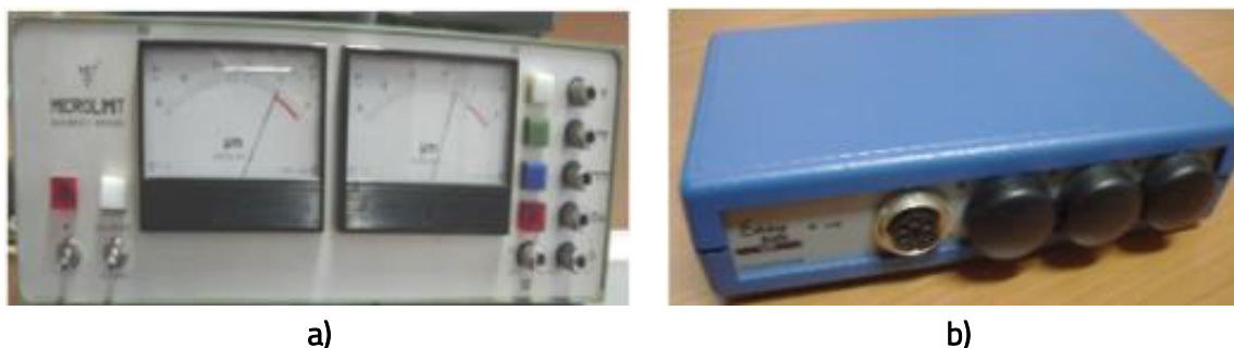
Fig. 4.4.4 Blocul electronic pentru alimentarea senzorilor inductivi HOTTINGER și Marposs Easy Box [M2]
