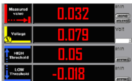
Fig. 4.5.4 Fereastra principală a aplicației software Smart Monitor 3 , pentru măsurarea asistată în timp real cu traductorul cu sursă LASER OMRON
