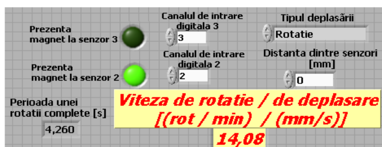
Fig. 4.5.6 Aspectul aplicației I.D.A.D.vi pentru monitorizarea vitezei de antrenare a piesei
