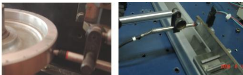
Fig. 4.5.8 Măsurarea în regim dinamic cu traductorul inductiv, MARPOSS
