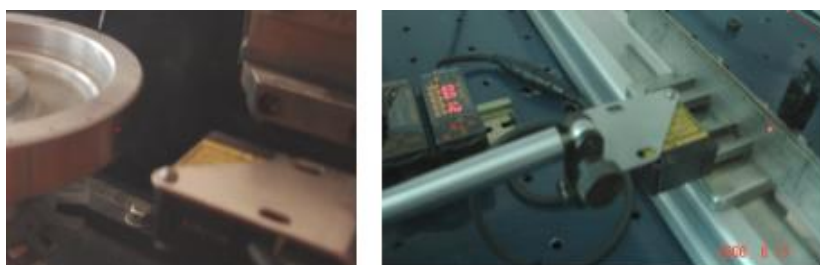
Fig. 4.5.12 Măsurarea cu traductorul de deplasare cu sursă LASER
