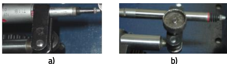
Fig. 4.4.2 Traductoarele de deplasare pe principiul inductiv, folosite în cadrul cercetării experimentale a - traductoarele HOTTINGER , b - traductoarele Easy Box
