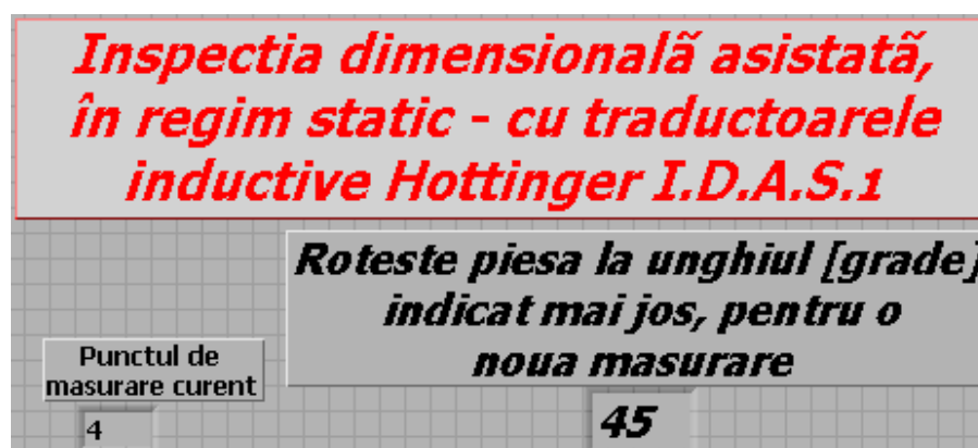
Fig. 2.7.1 Contorul numeric pentru informarea operatorului asupra necesității rotirii reperului, în scopul măsurării dimensionale punct cu punct
