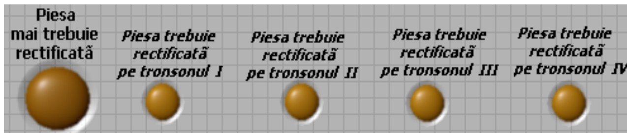
Fig. 2.4.8 Leduri de stare pentru indicarea gradului de finisarea piesei post proces sau în timpul procesului de aşchiere [B7]
