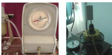
Fig. 4.4.8 Dispunerea traductorului de deplasare incremental pe instalația pneumatică
