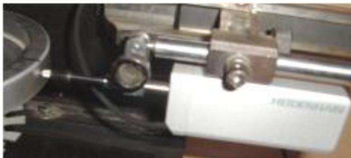
Fig. 4.4.5 Folosirea traductoarelor incrementale HEIDENHAIN în cadrul cercetării experimentale privind optimizarea inspecției dimensionale asistată
