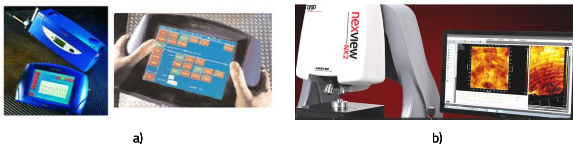
Fig. 1.2.10 Exemple de sisteme TALYSURF pentru controlul rugozității suprafețelor: a) prin contact; b) pe principiul optic [T3], [Z4]
